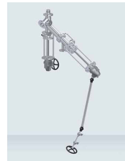
■ Typ BVS / Type BVS Kolbenventil-Kombination mit Handrad, Heizmantel und einem Zweitauftrittsstutzen mit Winkelgetriebe für Notentleerung Combined piston valve with hand wheel, heating jacket and a second outlet with angular gear (for emergency draining)
